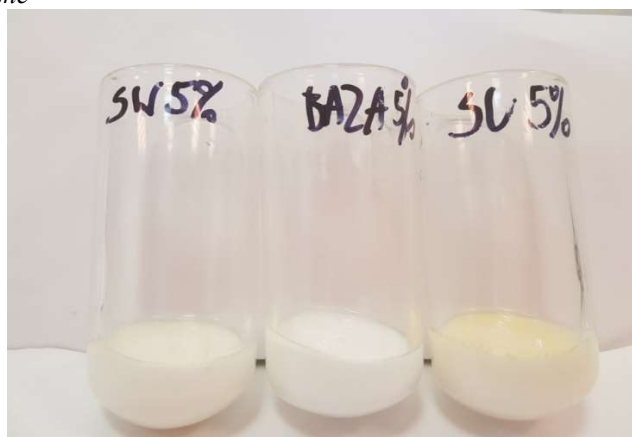
Fot. 14. Emulsje 5% po 24 godzinach przechowywania w cieplarni Źródło: opracowanie własne
