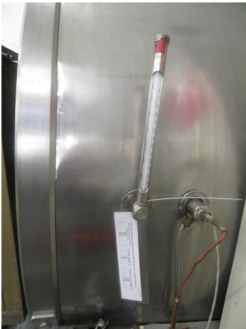
Zdjęcie 8. Rtęciowy termometr wzorcowy
