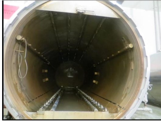
Zdjęcie 5. Wnętrze zbiornika autoklawu [źródło własne]
